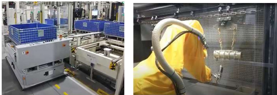
図 3.3 加工エリアの様子 (左：無人搬送車、右：塗装工程)
